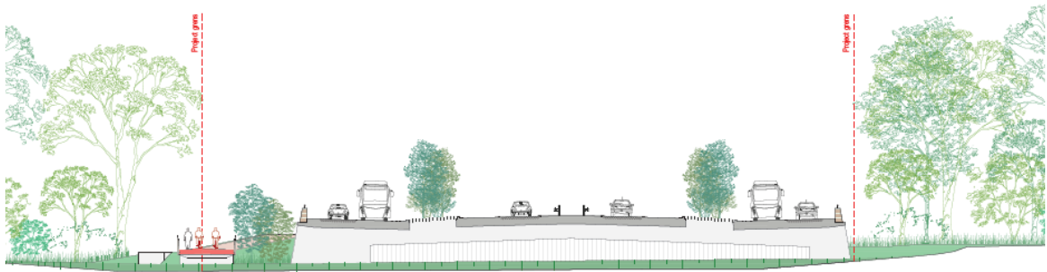
Figuur 12 - Langssnede van de ecopassage aan de Broekbeek
