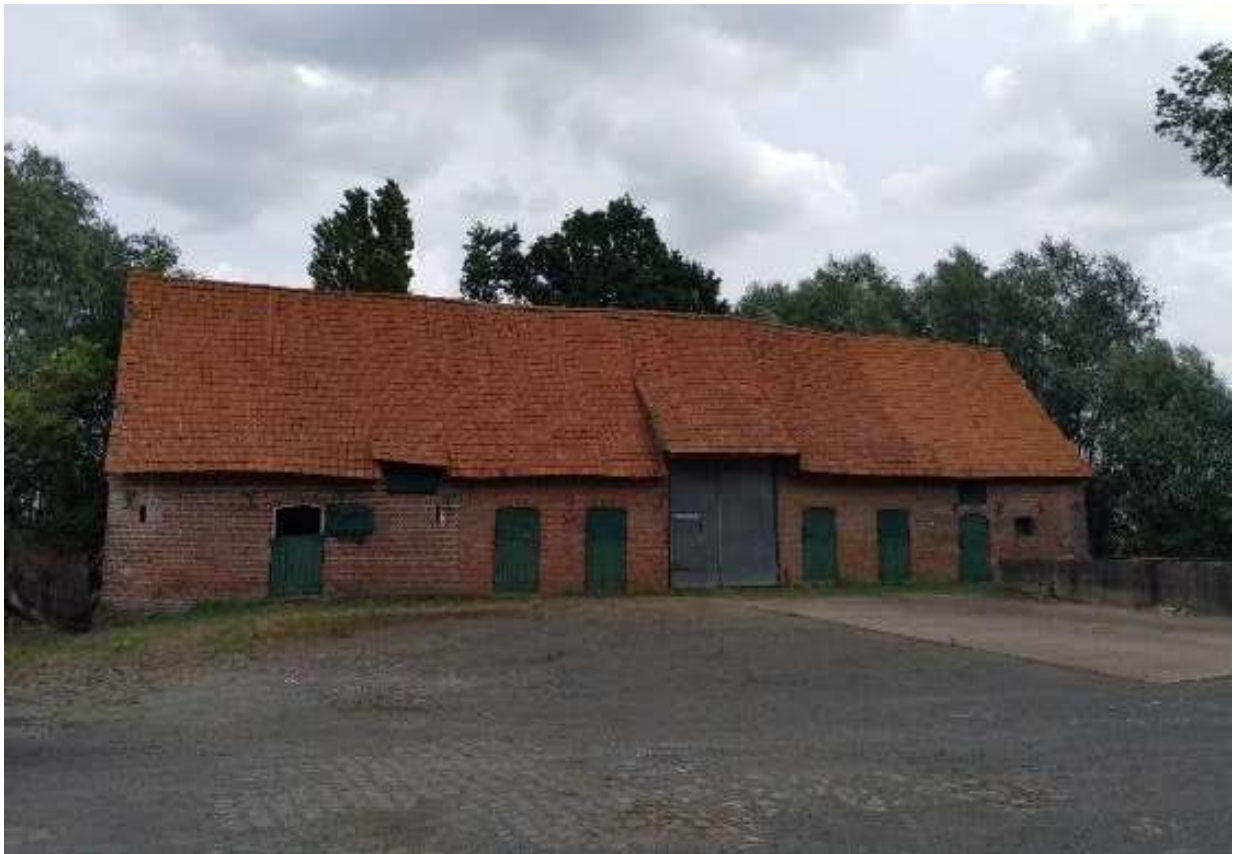
Foto 45: dwarsschuur in verankerde rode baksteenbouw, gevat onder zadeldak (rode mechanische pannen). Licht asymmetrische gevelopbouw van de erfgevel: de hoge schuurpoort onder een hogere dakoverstek, ongeveer in het midden, is geflankeerd door telkens drie staldeuren. Twee bewaarde houten laadvensters, links onder verhoogde dakoverstek. Het erf is deels verhard met kasseien en deels met bakstenen op hun kant. Onder de steenslagverharding, links van de schuurpoort, zijn de bakstenen muren van de vroegere mestvaalt bewaard (plaatsbezoek Onroerend Erfgoed 23.06.2023).
