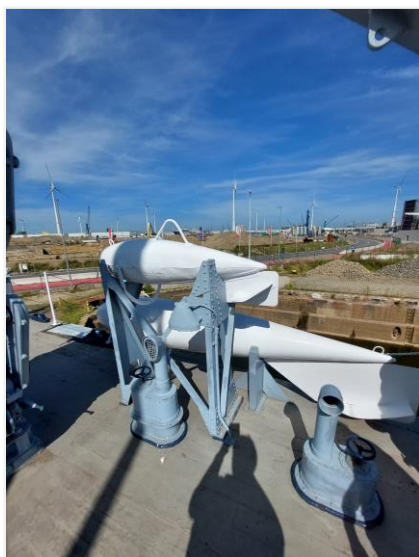
Foto 15: vlotters voor mijnbestrijding
