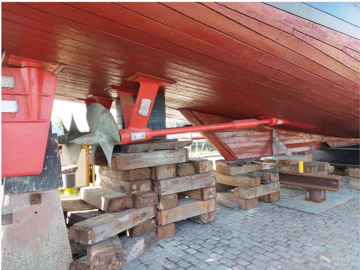
Foto 8: Onderschip met beide schroeven en schroefassen en beide roerbladen
