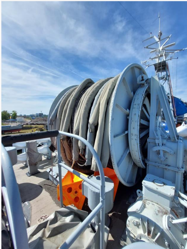
Foto 18: rol met drijver voor magnetische mijnbestrijding
