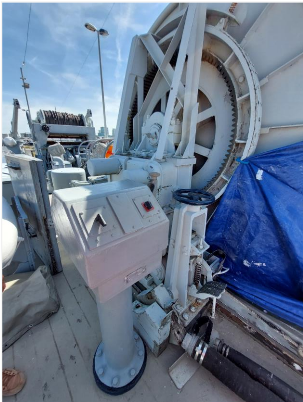
Foto 20: bediening van de lier (links) en remmechanisme rechts
