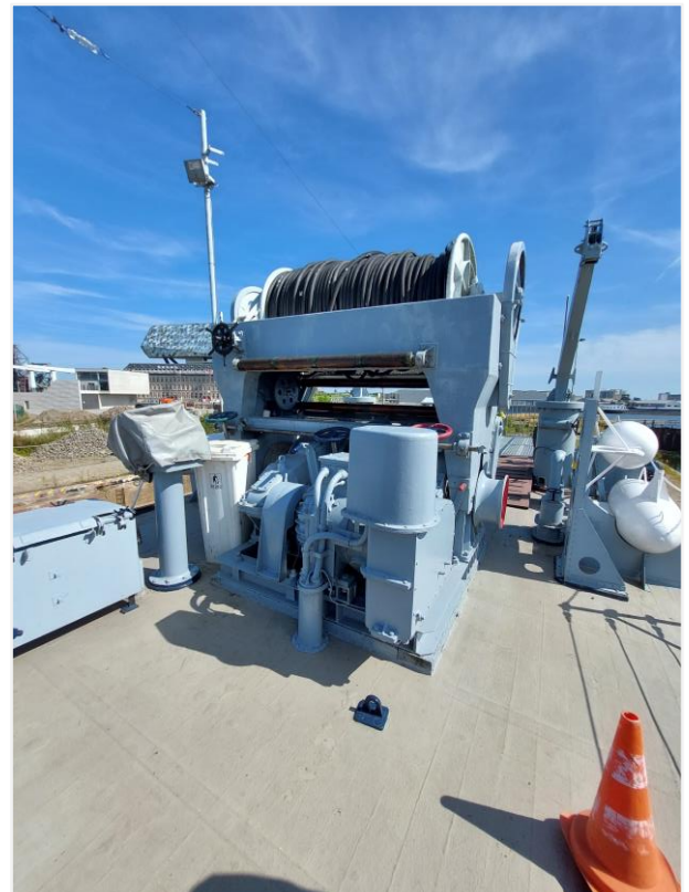
Foto 21: motor en lier met bedieningsinstrumenten
