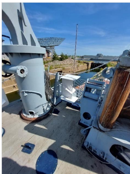
Foto 13: scheerbord voor bestrijding contactmijnen
