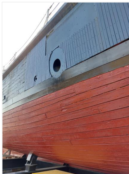
Foto 6: detail stuurboord uitlaat veegmotor en verticale beplanking
