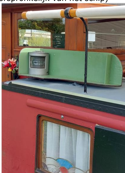
Foto 11: navigatielicht stuurboord. De zwart geschilderde stalen stormluiken ter bescherming van de roefvensters
