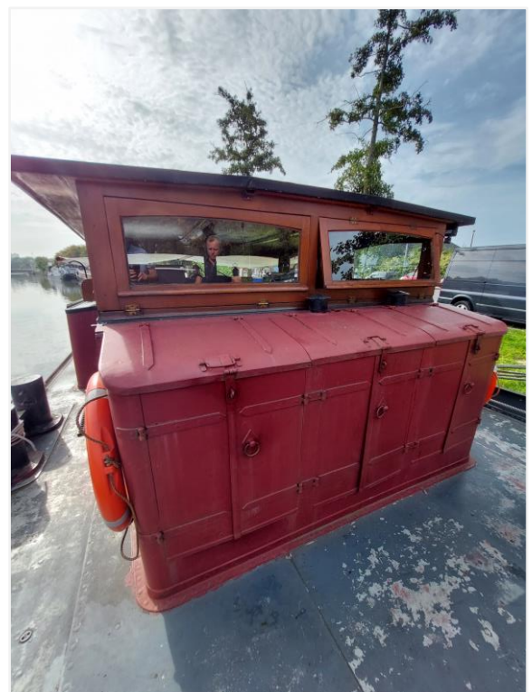
Foto 6: stuurhuis met kombuis: links toegang tot machinekamer, in het midden kon het fornuis staan en rechts was de verplichte tweede toegang tot de machinekamer.
