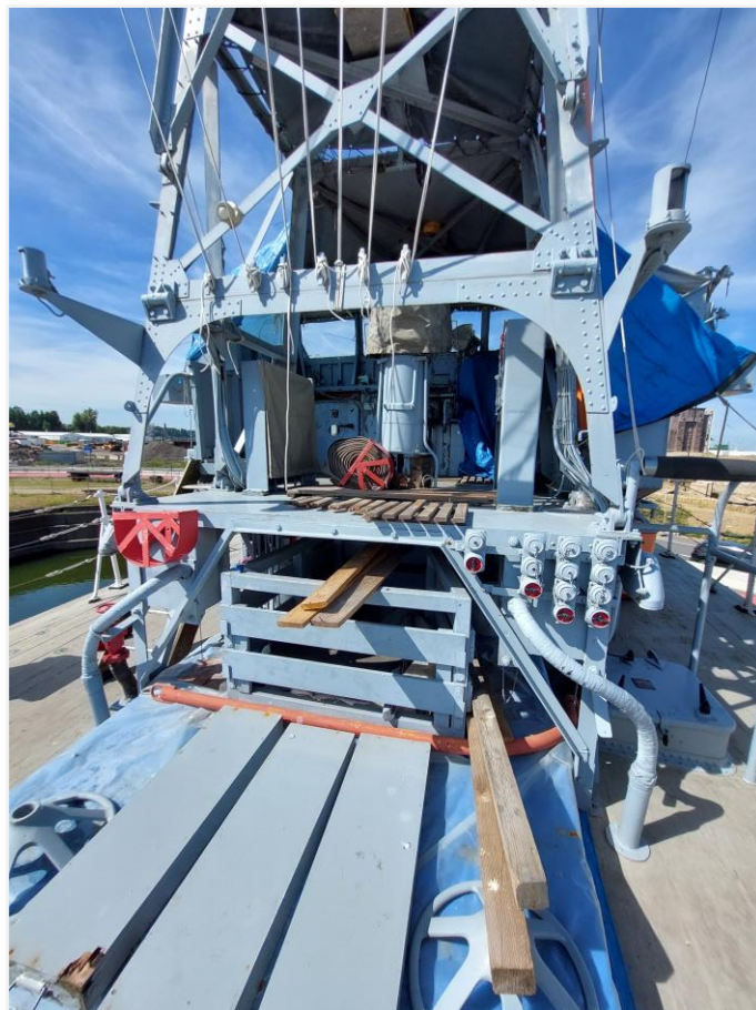
Foto 25: Zicht achteraan op de brug: onder de mast links en rechts brandbestrijding en centraal het kompas. Achteraan ontbreekt de vlaggenkast (inmiddels gerestaureerd maar wacht op terugplaatsing) rechts van de mast aan stuurboord bevindt zich het luik dat toegang geeft tot de veegmachinekamer.
