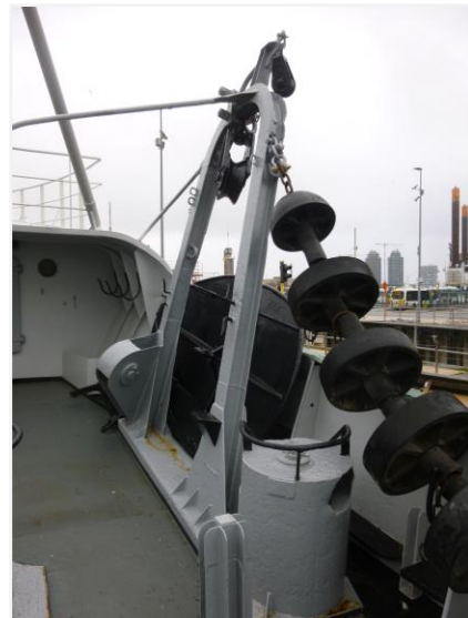
Foto 7: stuurboord: gedeelte stormkap, galg, bord en vistuig
