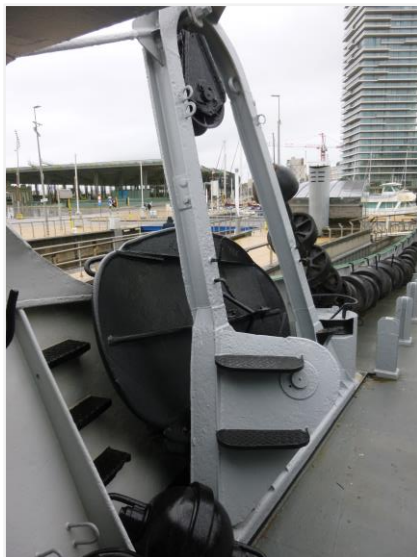
Foto 6: stuurboord: galg met bord en vistuig
