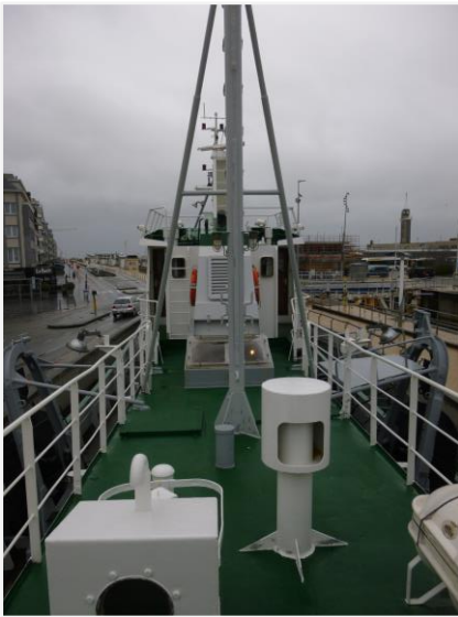
Foto 13: Opperdek met centraal de bezaanmast, schouw met uitlaten en beide achterste galgen
