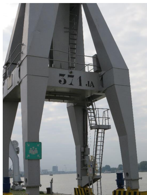
Foto 5: Portaal op vier poten (in kokerstructuur) met buitentrap naar bordes (14.10.2021).
