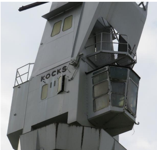
Foto 13: Draaibare bovenbouw met machinekamer en stuurcabine onder de giek (14.10.2021).
