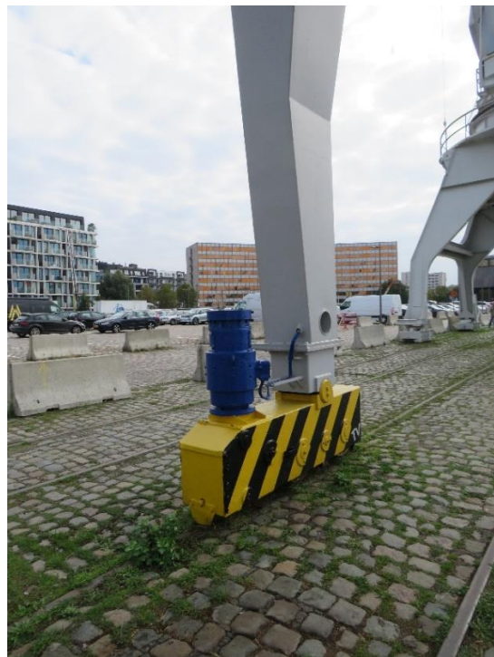
Foto 9: Portaalpoot met bogie met motor (landzijde) (14.10.2021).
