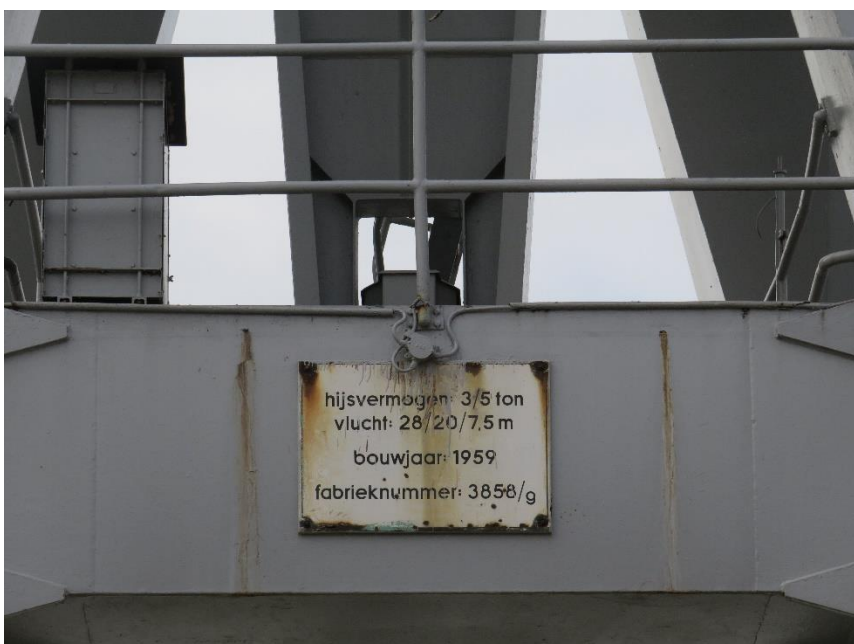
Foto 4: Origineel plaatje met kraankenmerken op portaal (14.10.2021).
