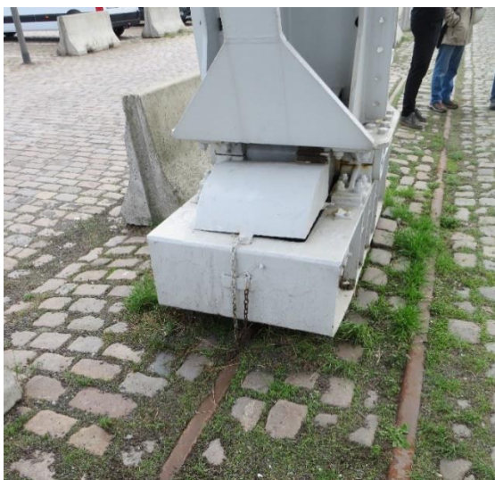
Foto 8: Portaalpoot met bogie (landzijde) (14.10.2021).
