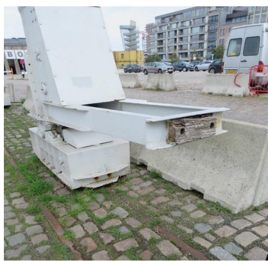
Foto 9: Portaalpoot met bogie (landzijde) (14.10.2021).
