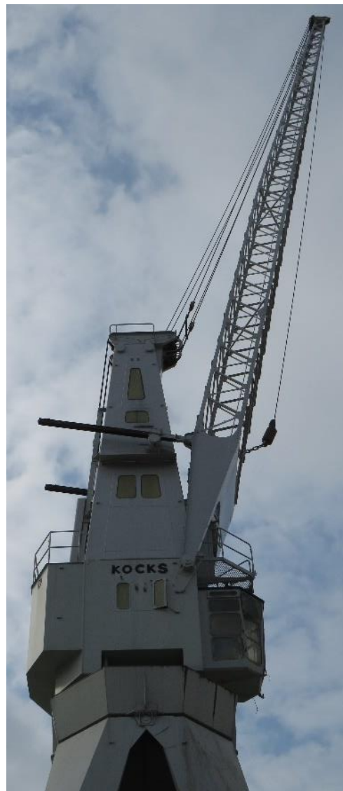
Foto 18: Machinekamer met stuurcabine, toren en giek (14.10.2021).
