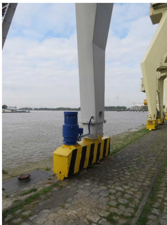
Foto 7: Portaalpoot met bogie met motor (kaaizijde) (14.10.2021).
