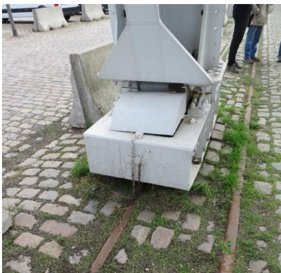
Foto 8: Portaalpoot met bogie (landzijde) (14.10.2021).
