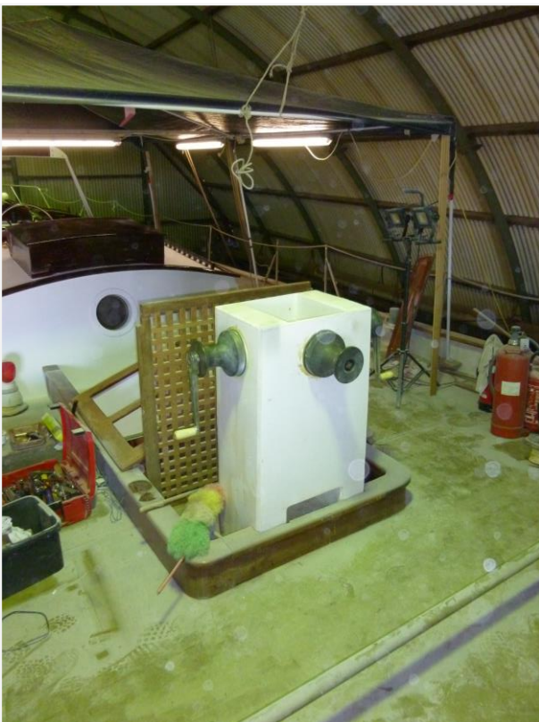
Foto 9: mastvoet met daarachter lichtluikje verblijf
