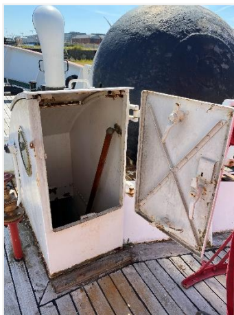
Foto 10: trap op voordek naar werkruimte met ankerlier en kettingmagazijn
