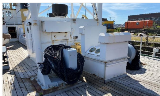
Foto 16: achterschip met bovenlichten batterijruimte tussendek
