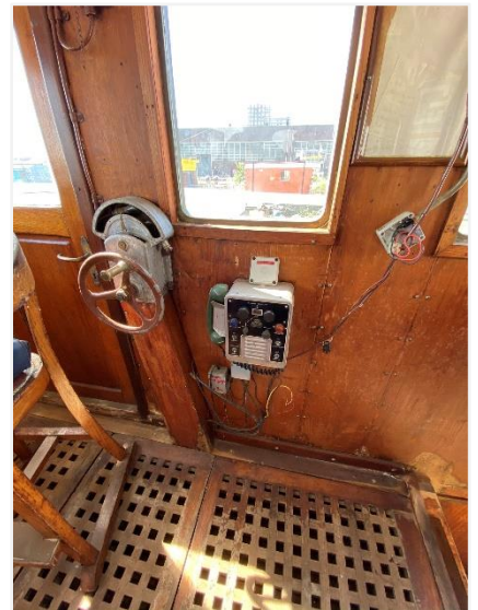
Foto 122: telegraaf, firma Chadburn, Liverpool
