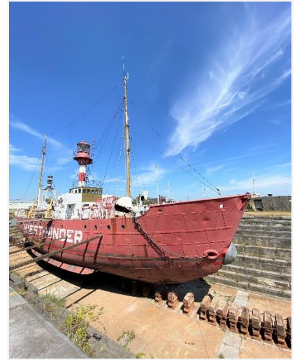
Foto 3: voorsteven met onderschip en langskiel
