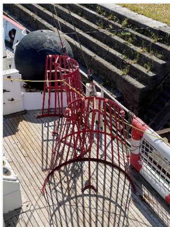
Foto 9: tweeledig lateraal bakboordteken dat in de mast werd gehesen
