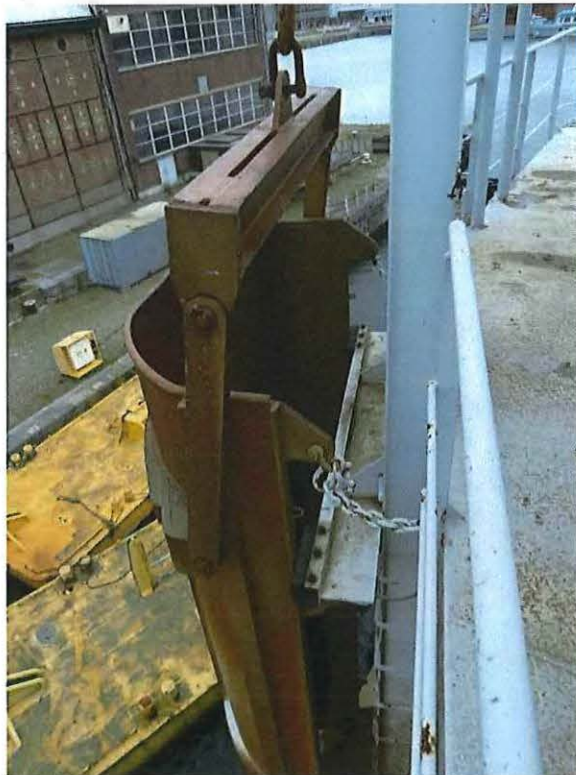
Foto 22: De stortgoot aan stuurboord in verticale stand.
