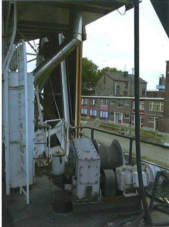
Foto 21: Lier voor bediening van de stortgoot.
