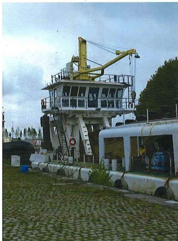
Foto 6: Ladderlierbok met zestonskraan.
