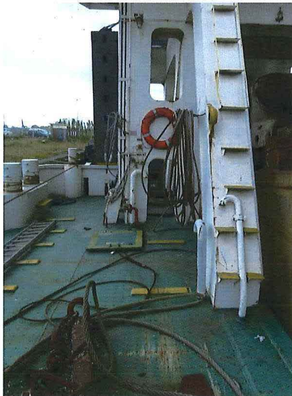
Foto 34: Het voordek met de beschermingsstrips (in het geel).
