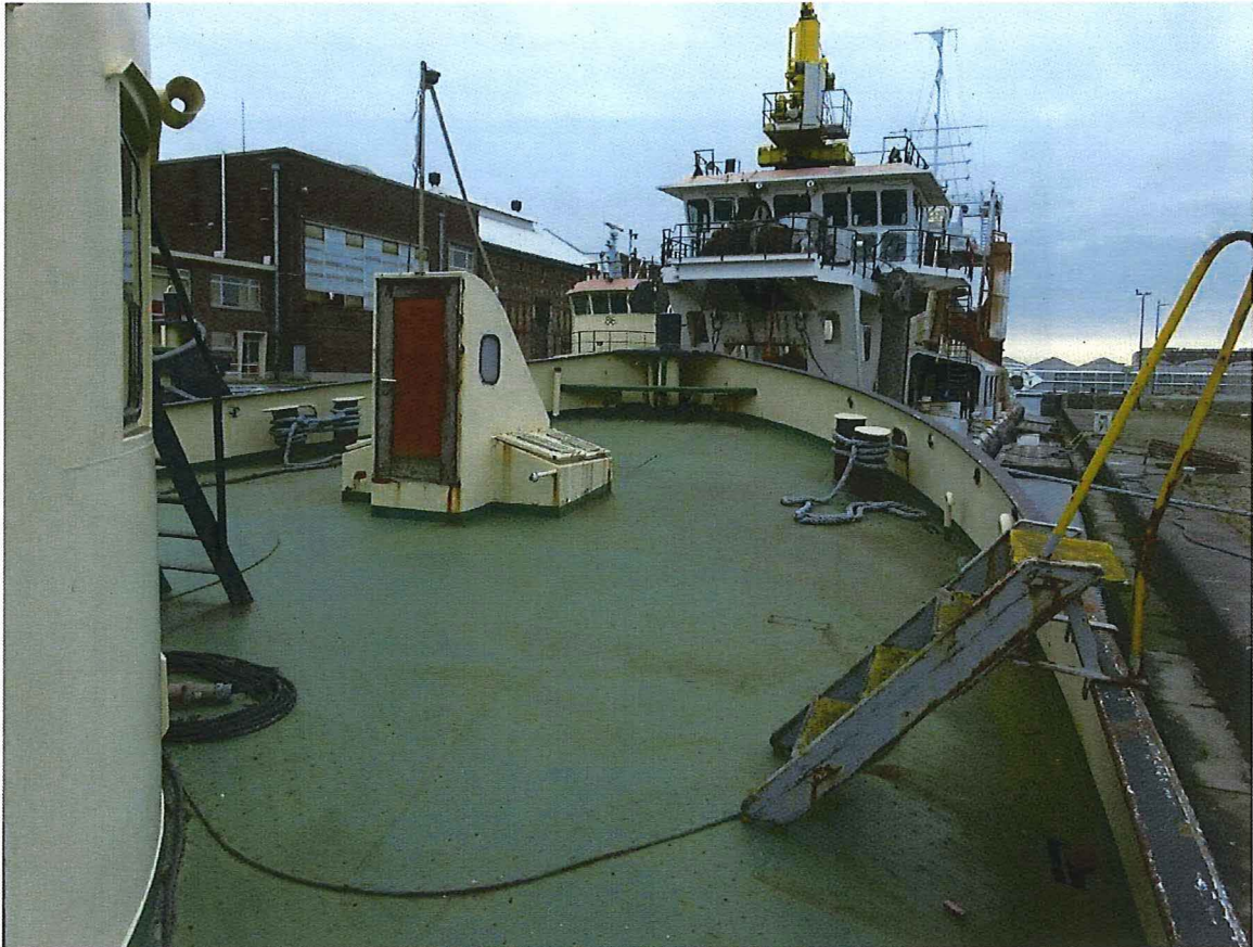
Foto 5: Voordek met bolders en toegang tot het vooronder.
