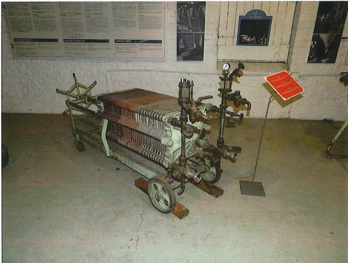
Foto 82: Platenfilter, opgesteld op de zolder van de mouterij (08/05/2018).
