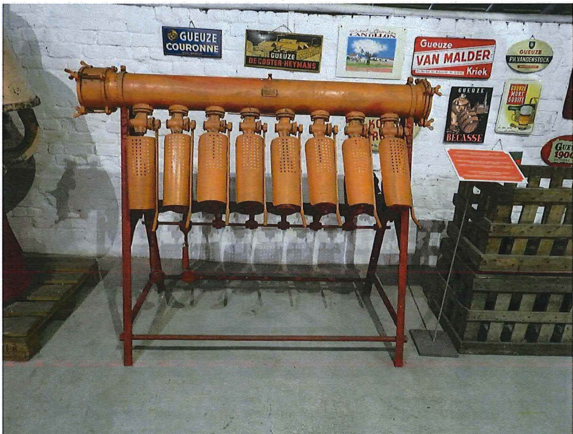
Foto 80: Manuele flessenvuller (begin 20 ste eeuw?), opgesteld op de zolder van de mouterij (08/05/2018)
