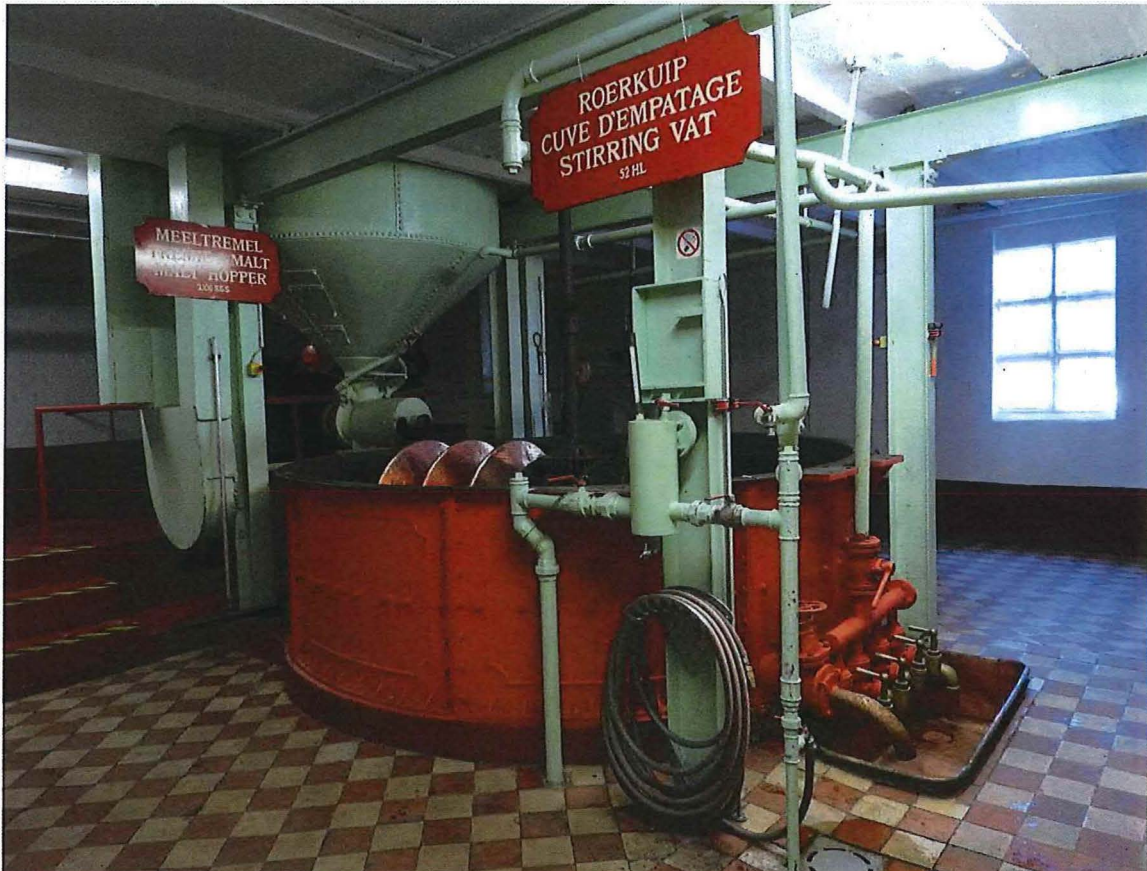
Foto 44: Interieur brouwerij, brouwzaal eerste verdieping, roerkuip en meeltremel (05/02/2018).
