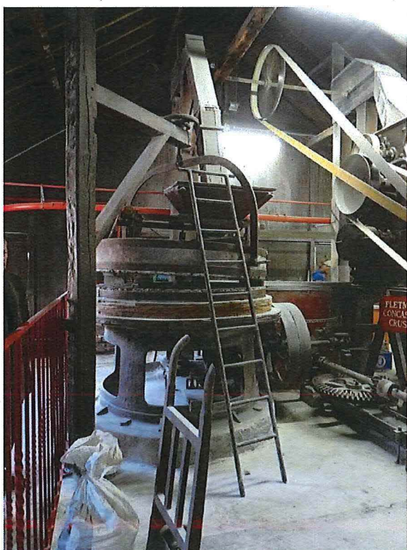
Foto 54: Interieur brouwerij, tweede verdieping, molen met maalstenen (05/02/2018).
