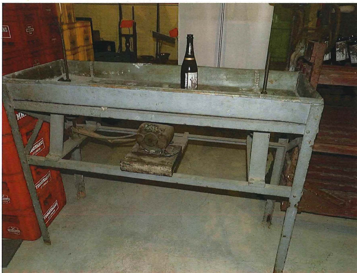
Foto 84: Mechanisch aangedreven flessenreiniger, opgesteld op de zolder van de mouterij (08/05/2018).
