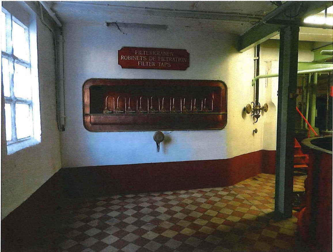
Foto 46: Interieur brouwerij, brouwzaal eerste verdieping, filterkranen (05/02/2018).
