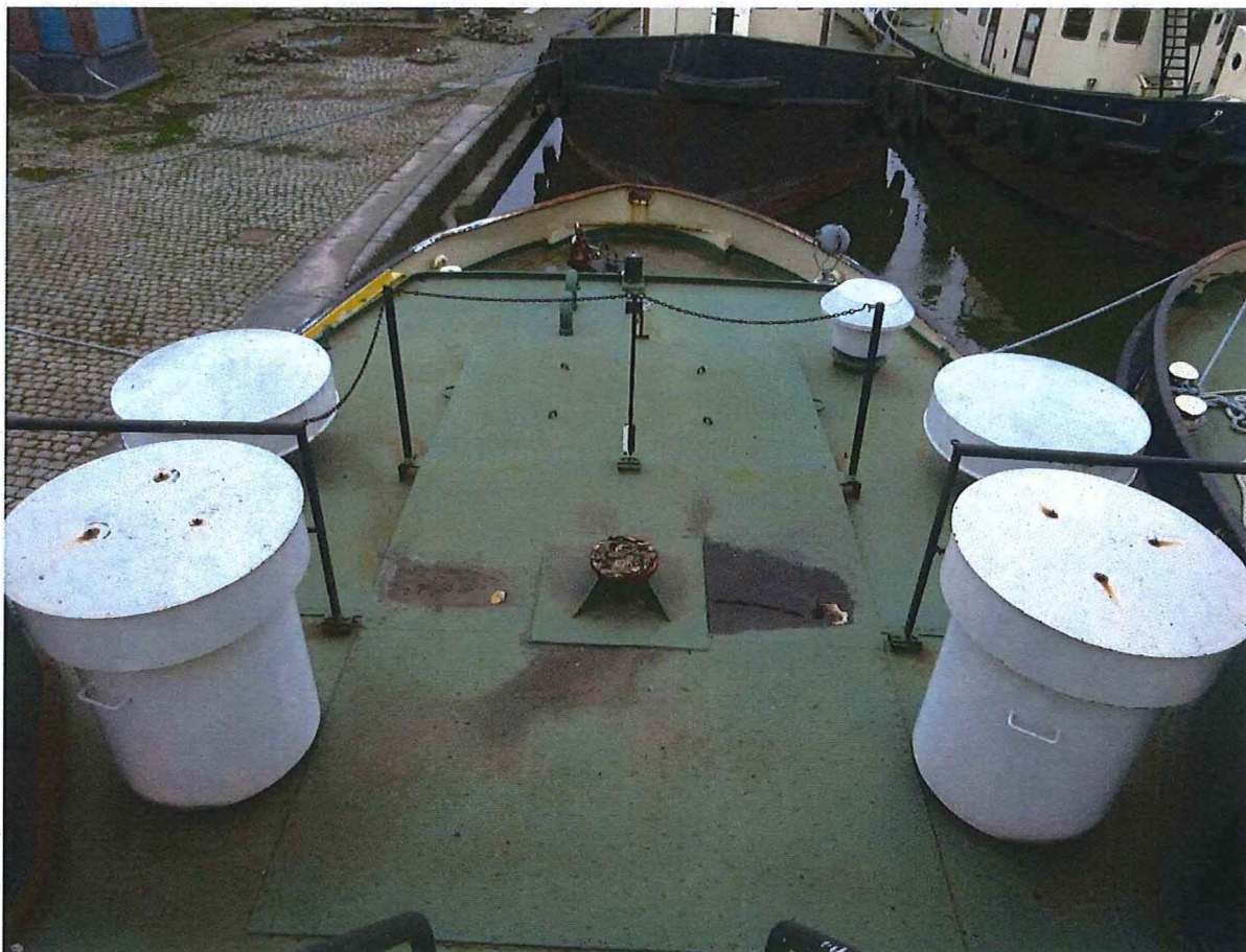
Foto 12: Roef boven de motorschacht met luchthappers.
