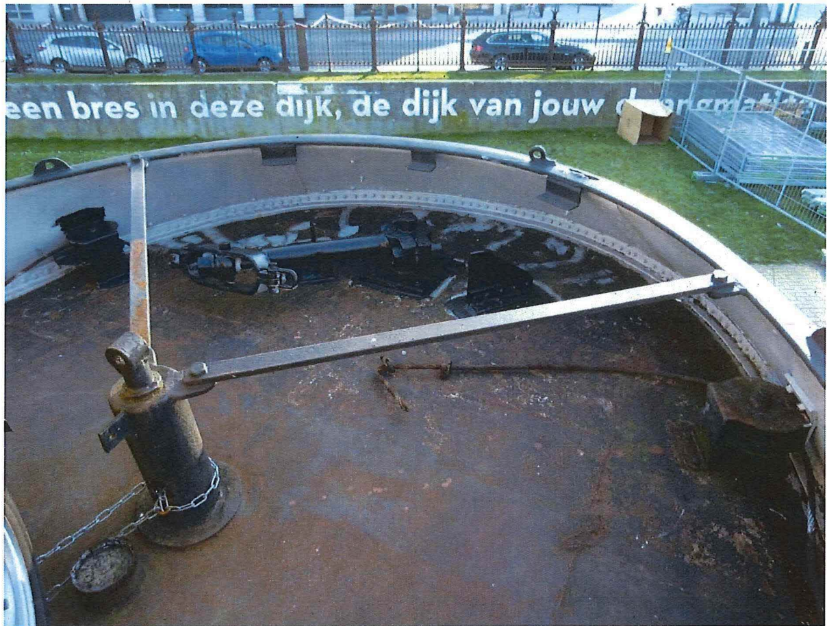
Foto 29: De stuurinrichting op het achterdek. De stuurstangen zijn bevestigd aan een stalen kabel die langs een begeleidingsblok loopt en vervolgens aan een korte helmstok is bevestigd. Ook zichtbaar zijn de voet van de baggermast (afgezaagd) en enkele versterkingen van het achterdek.
