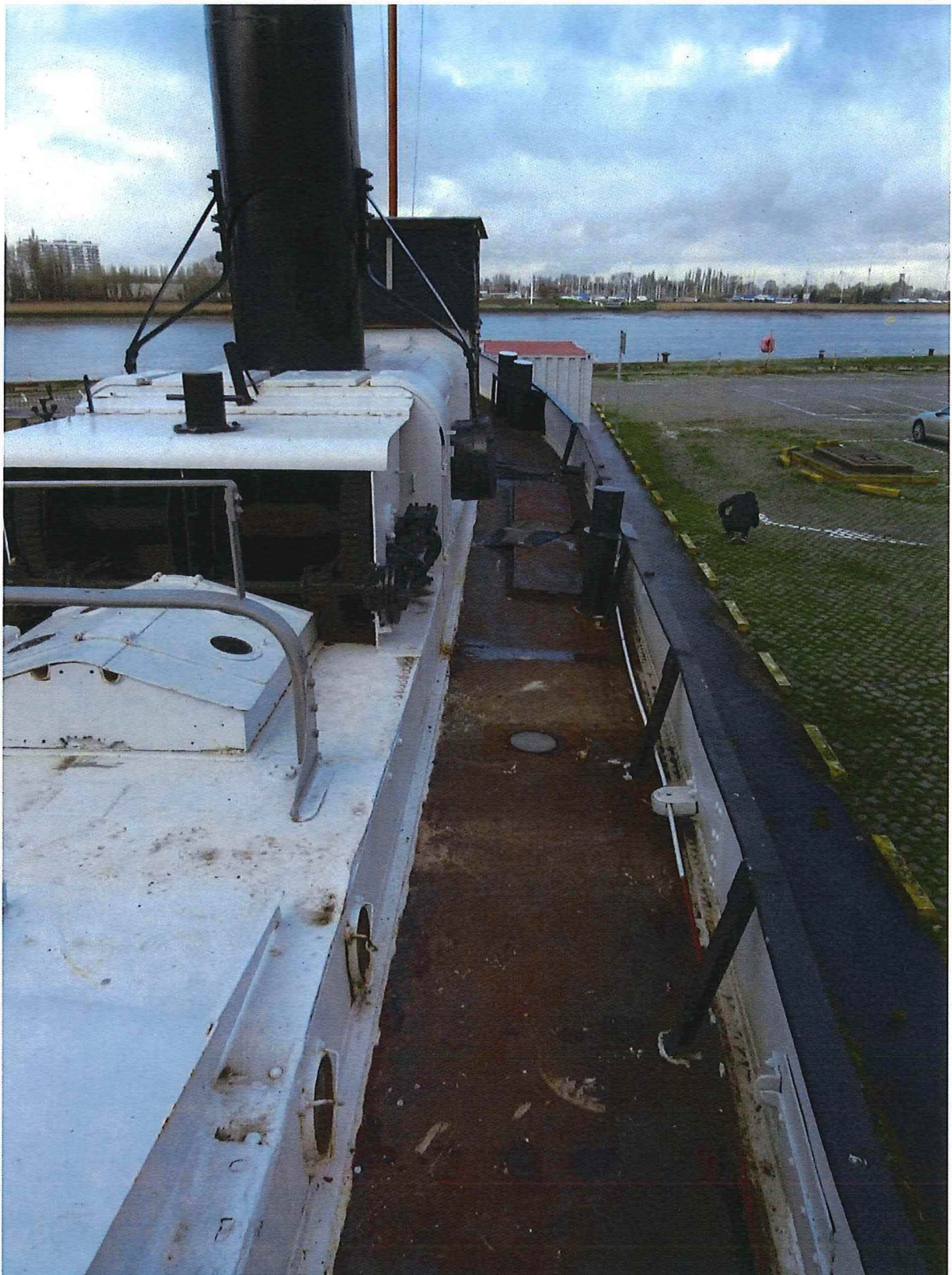
Foto 18: Gangboord aan stuurboordzijde, met spuigaten, versterking van het boeisel en de stuurstang.
