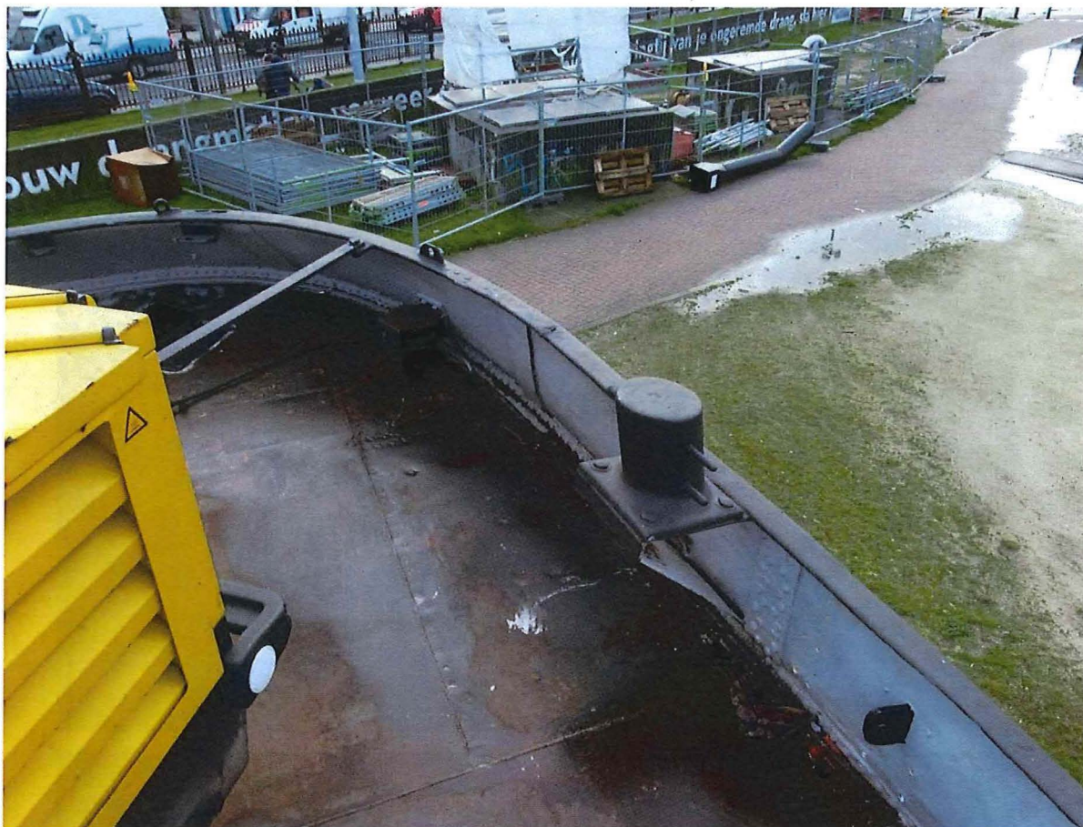
Foto 30: Zicht op het achterdek met bolder en nog deels geklinknageld dek.
