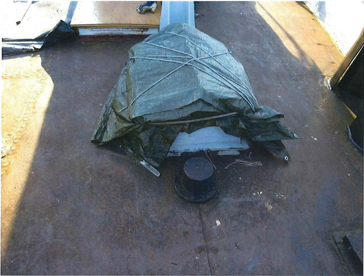
Foto 11: Vlak voor de mastvoet zorgt een koekoek voor licht en lucht in het woonvertrek benedendeks. De koekoek is afgedekt om lekken te vermijden.
