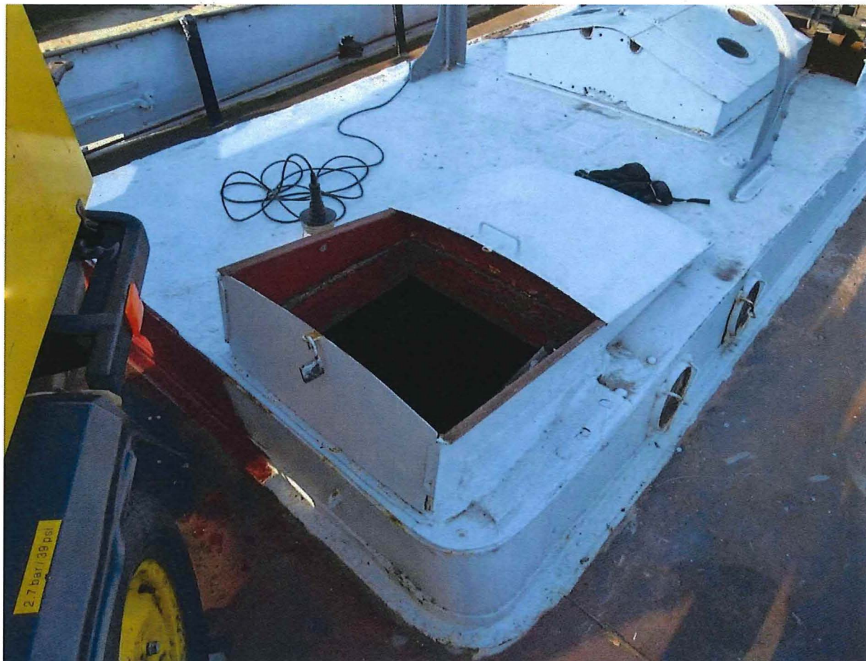
Foto 22: De toegang tot het achteronder.
