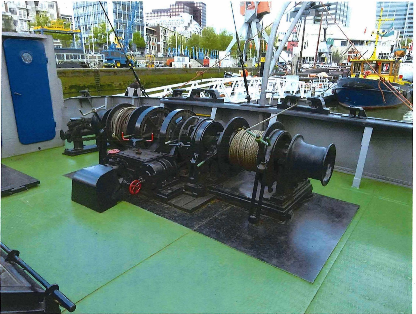
Foto 26: Anker- en verhaallier op het voordek. Met bolder, verhaalklampen, davit en uiterst links het toilet.
