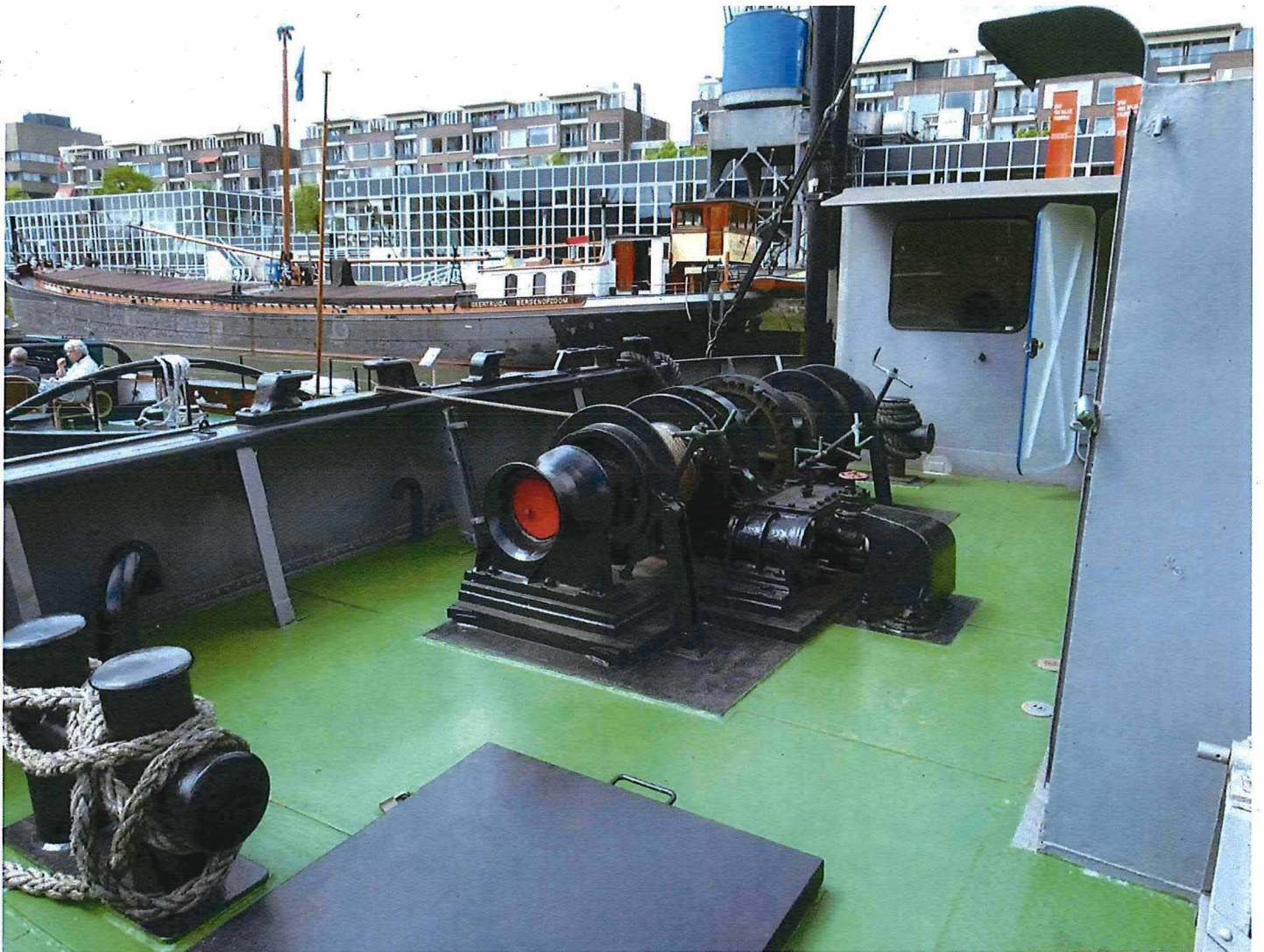
Foto 22: Achterdek met de verschansing, de kombuis, de verhaal- en ankerlier, de bolder en de toegang tot de schipperswoning.
