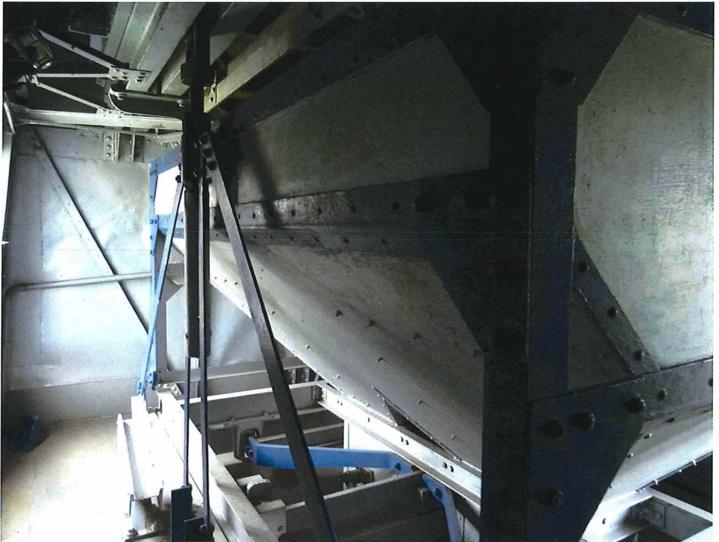
Foto 13: Weegbak waarin ongeveer 3000 kilogram kon worden gewogen.
