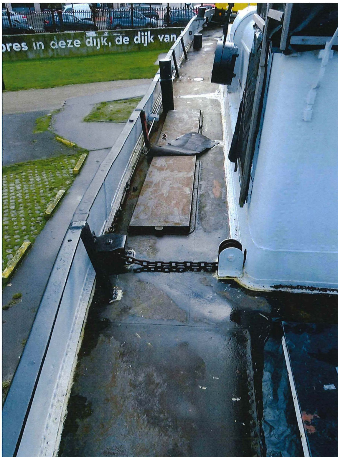
Foto 16: De gangboord aan stuurboordzijde, met de geleidingsblokken voor de stuurketting, met de twee luiken van de kolenbunker, het boeisel en het geklinknagelde dek.
