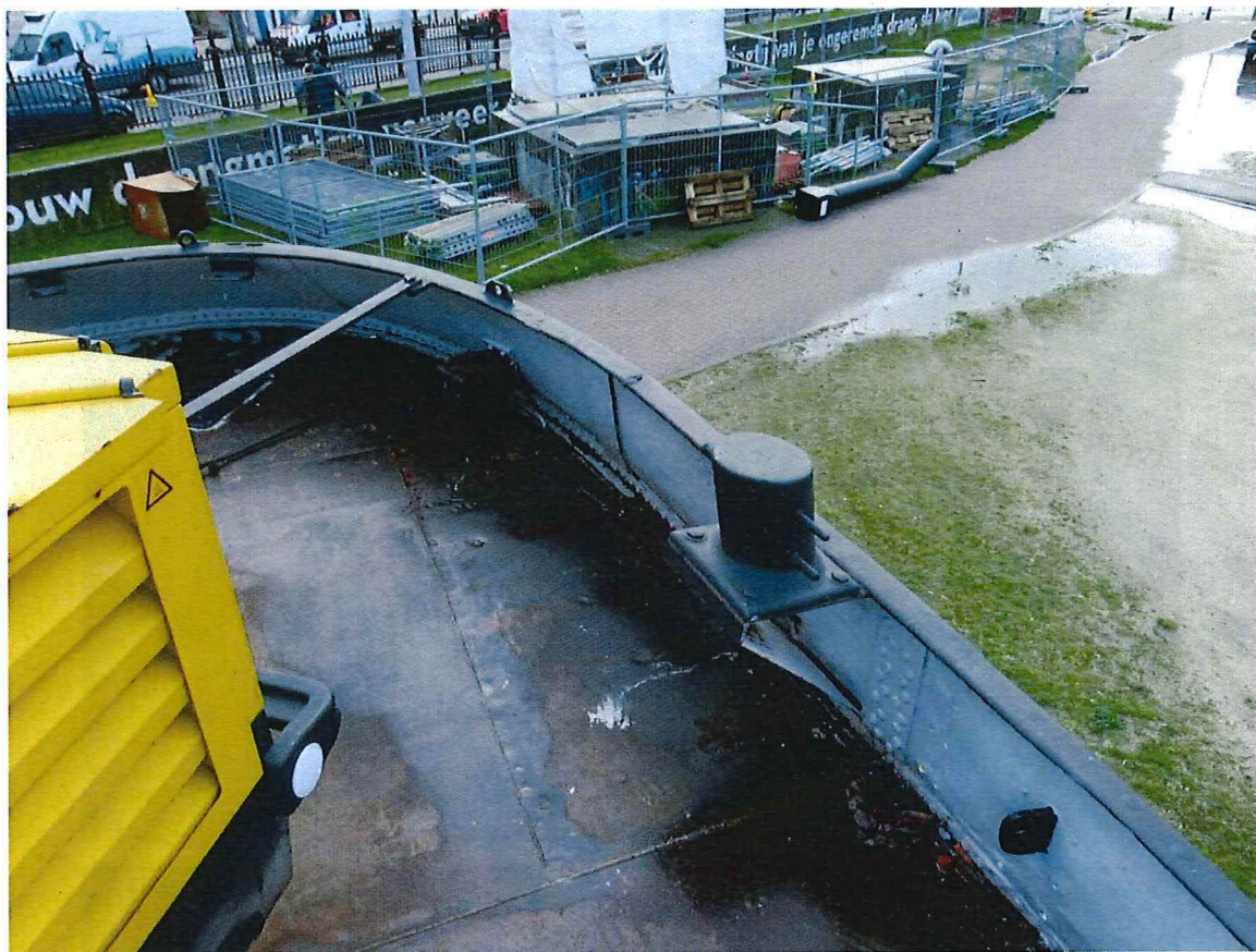
Foto 30: Zicht op het achterdek met bolder en nog deels geklinknageld dek.
