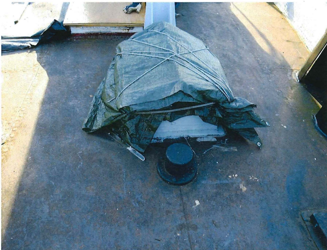
Foto 11: Vlak voor de mastvoet zorgt een koekoek voor licht en lucht in het woonvertrek benedendeks. De koekoek is afgedekt om lekken te vermijden.
