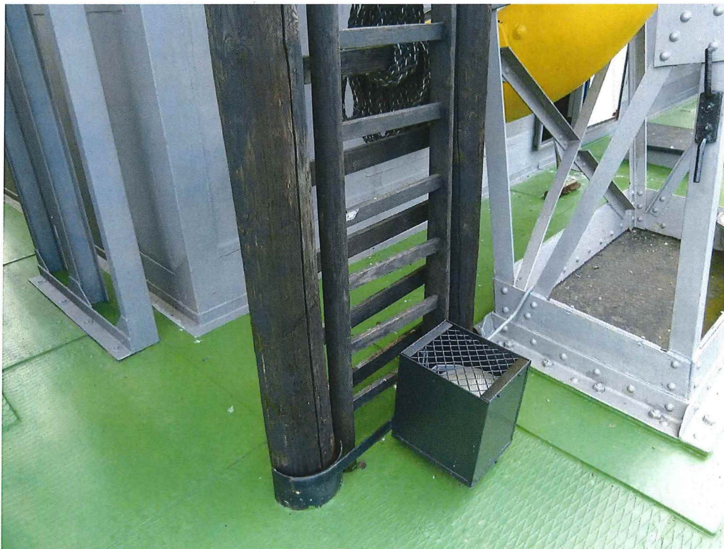
Foto 28: De basis van de ladder om aan boord van zeeschepen te klimmen.
