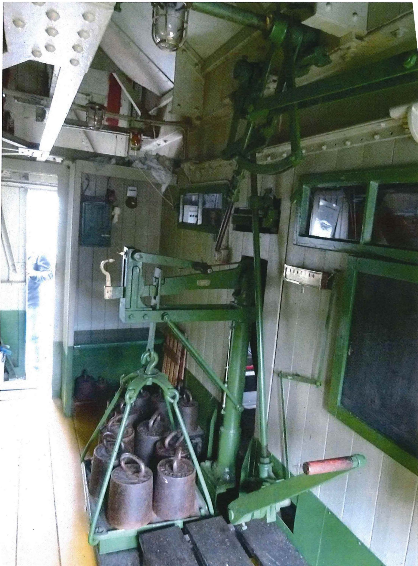
oto 15: Kamer voor de bediening van de weegschaal en de schuif van de weegbak.
