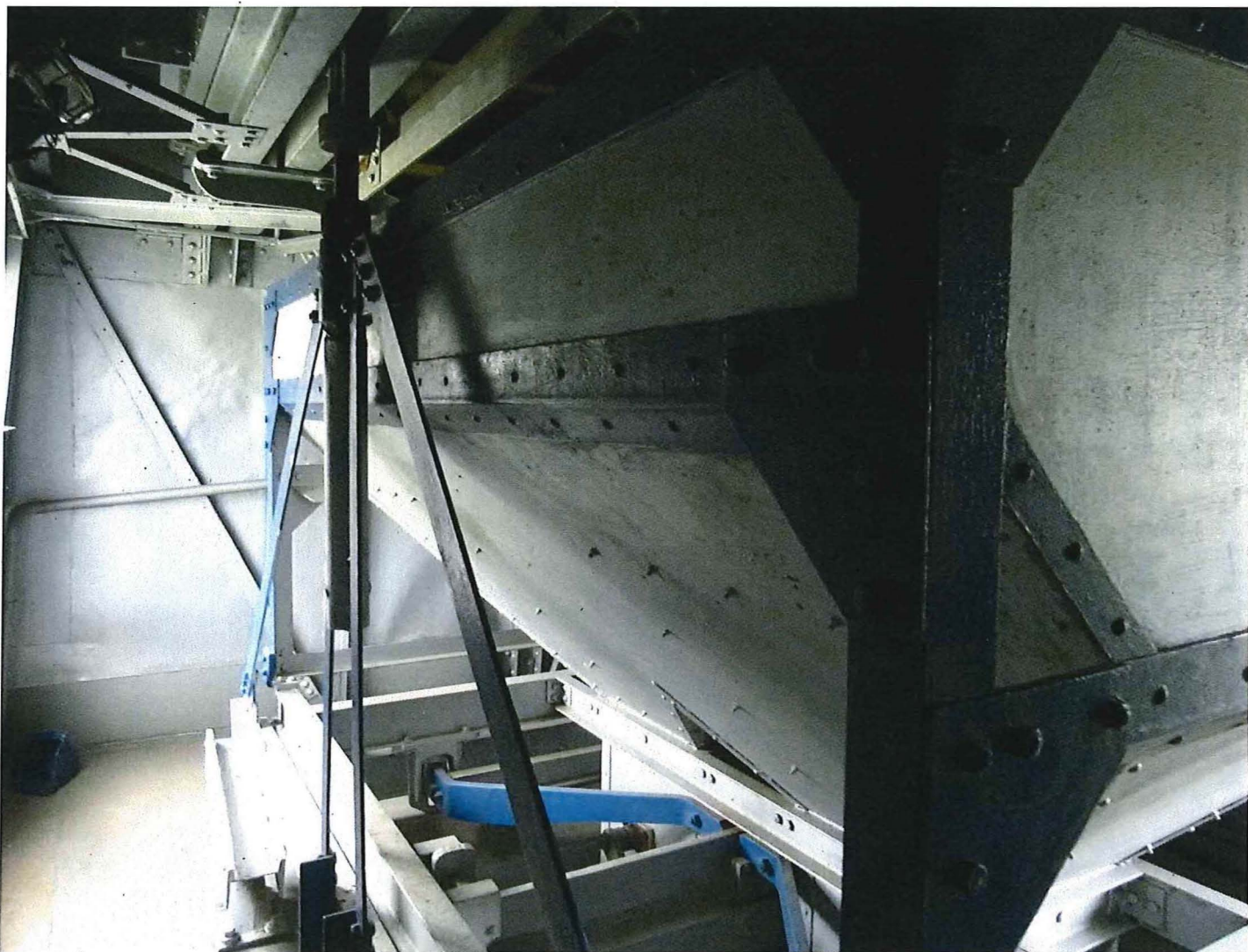
Foto 13: Weegbak waarin ongeveer 3000 kilogram kon worden gewogen.
