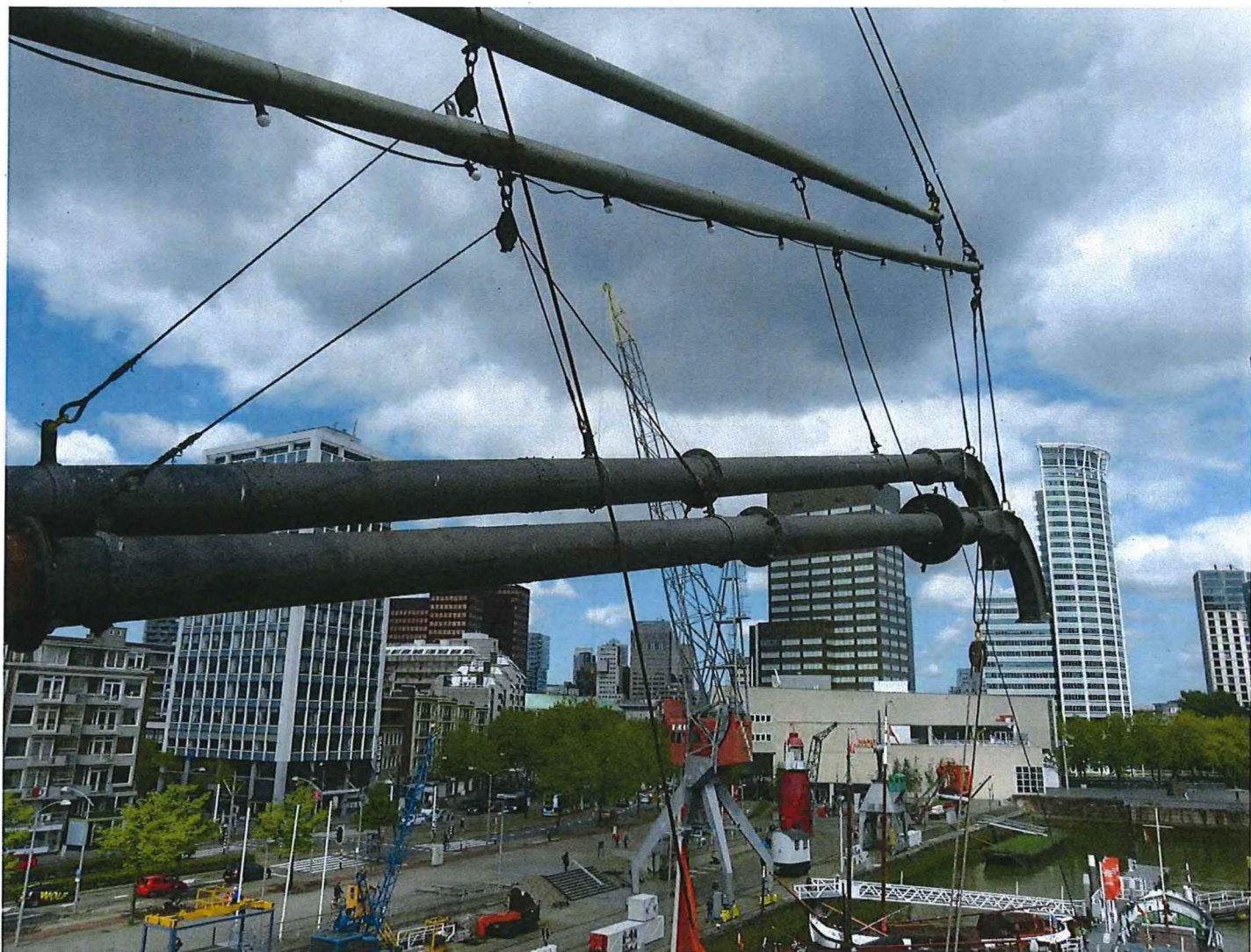
Foto 19: Zicht op de graanzuigleidingen en de ophanging aan de gieren.
