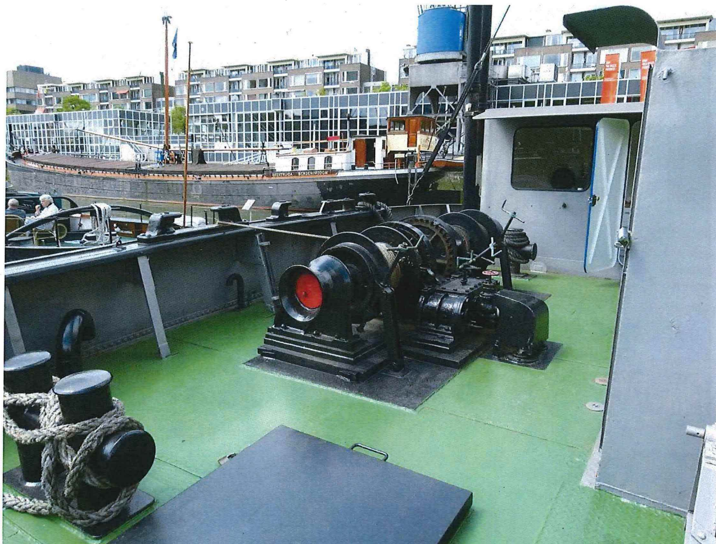
Foto 22: Achterdek met de verschansing, de kombuis, de verhaal- en ankerlier, de bolder en de toegang tot de schipperswoning.
