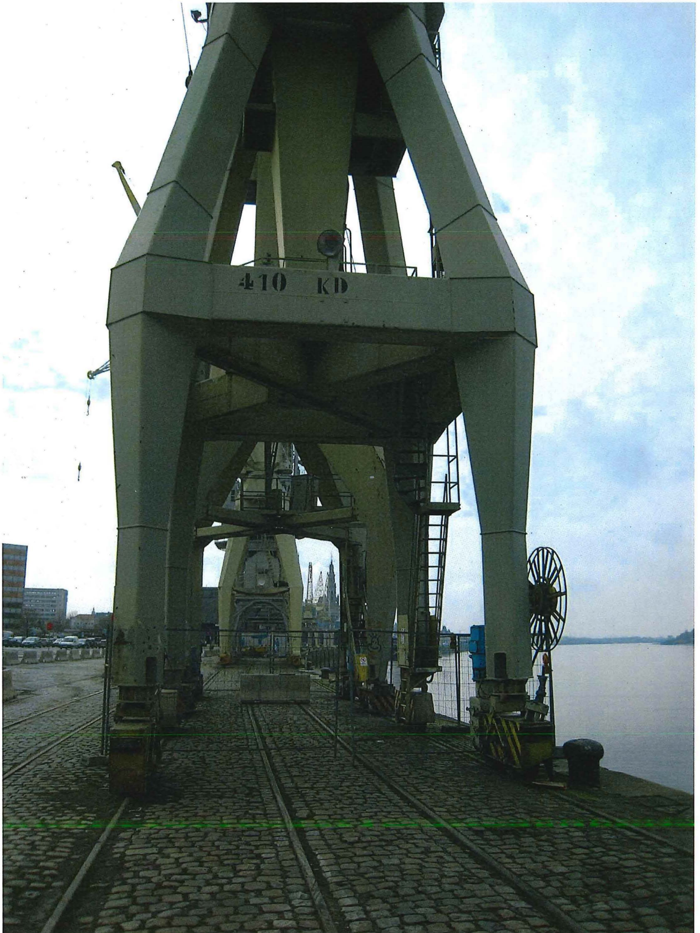
Foto 5: Het portaal van de 410 KD staat op de sporen van de Rijnkaai van vijf meter breedte.
