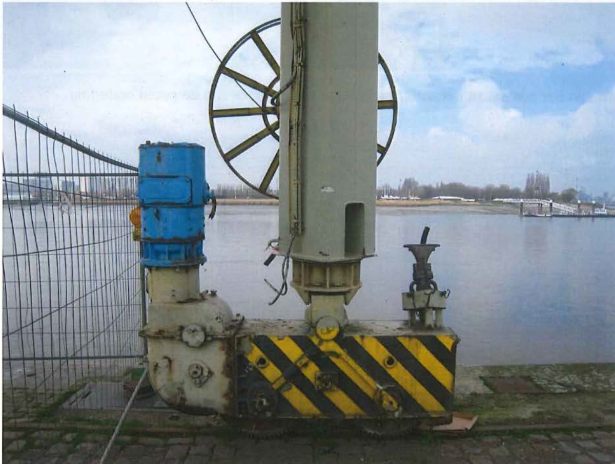
Foto's 6 en 7: De kraan rust op vier bogies. Twee van de vier bogies worden aangedreven door een aangeflenste elektromotor.
