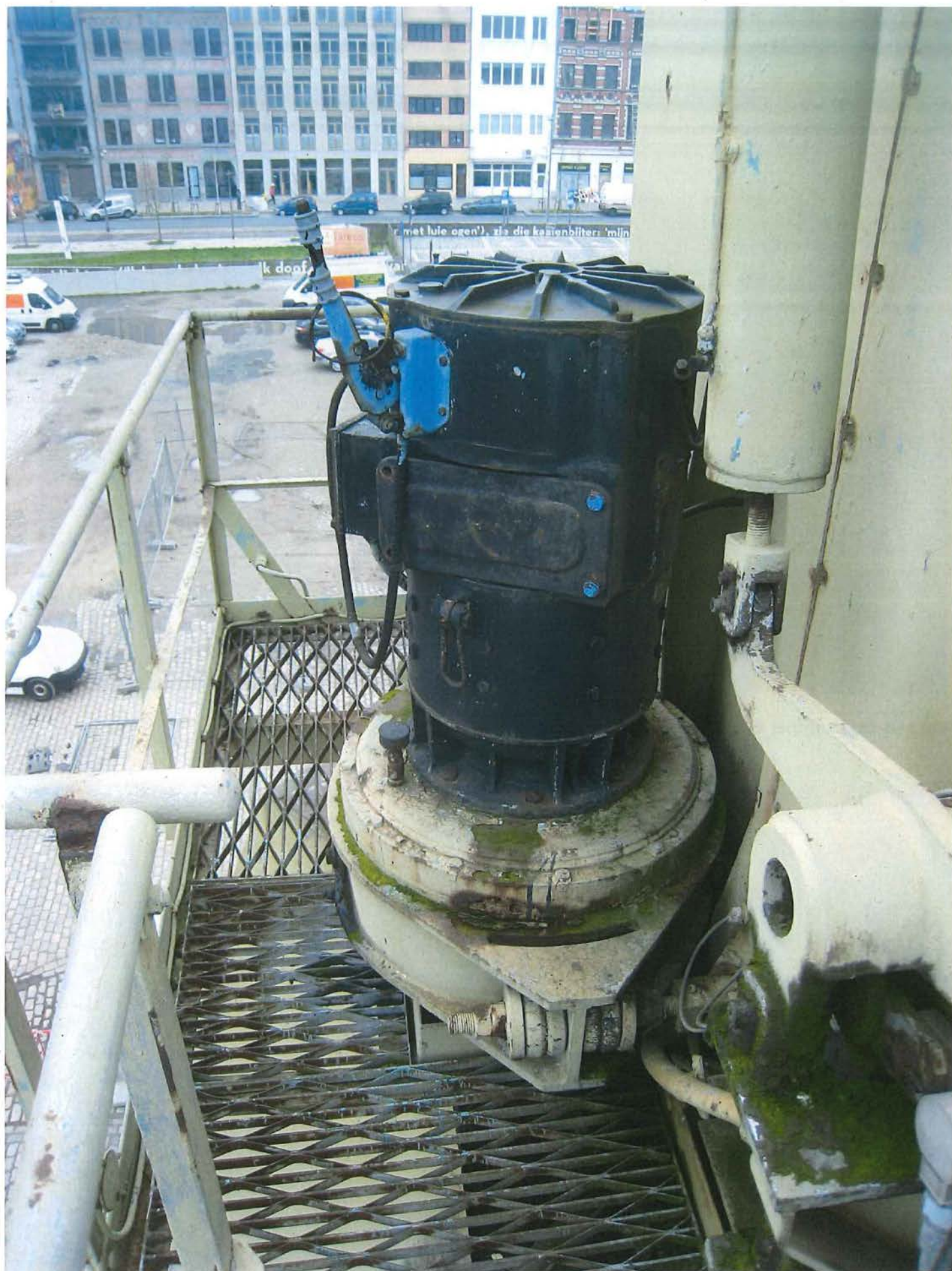
Foto 8: De elektromotor voor het zwenken van de toren op het bordes.
