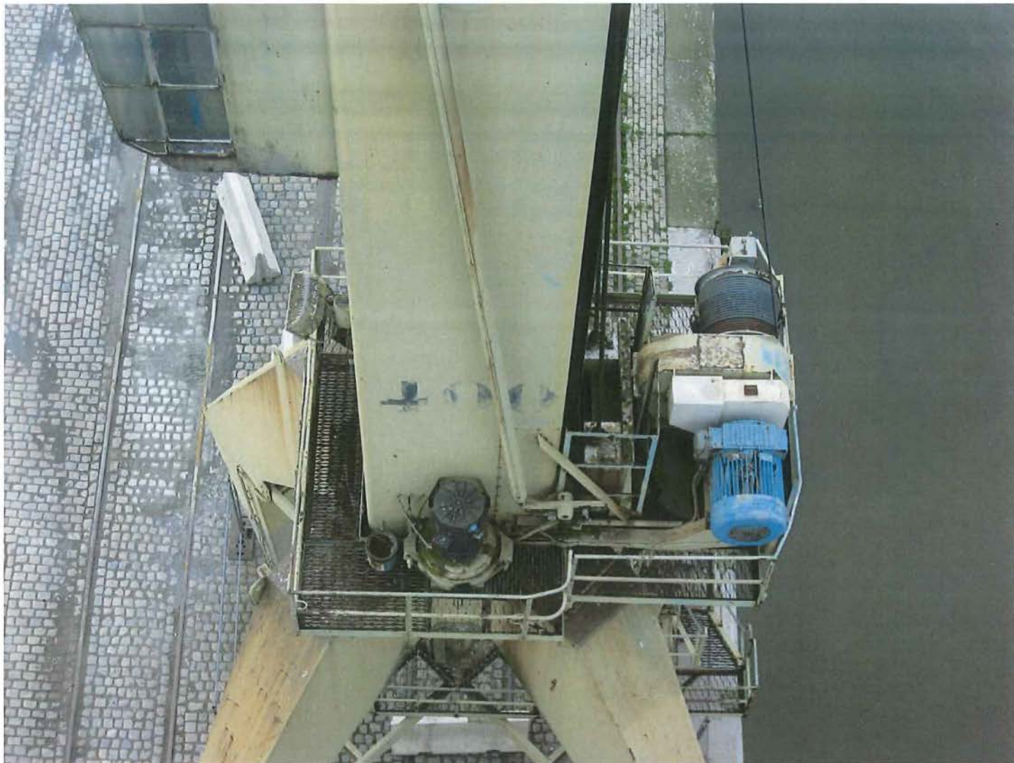
Foto 6: Het bordes met de mechanismen om te zwenken en te hijsen.
