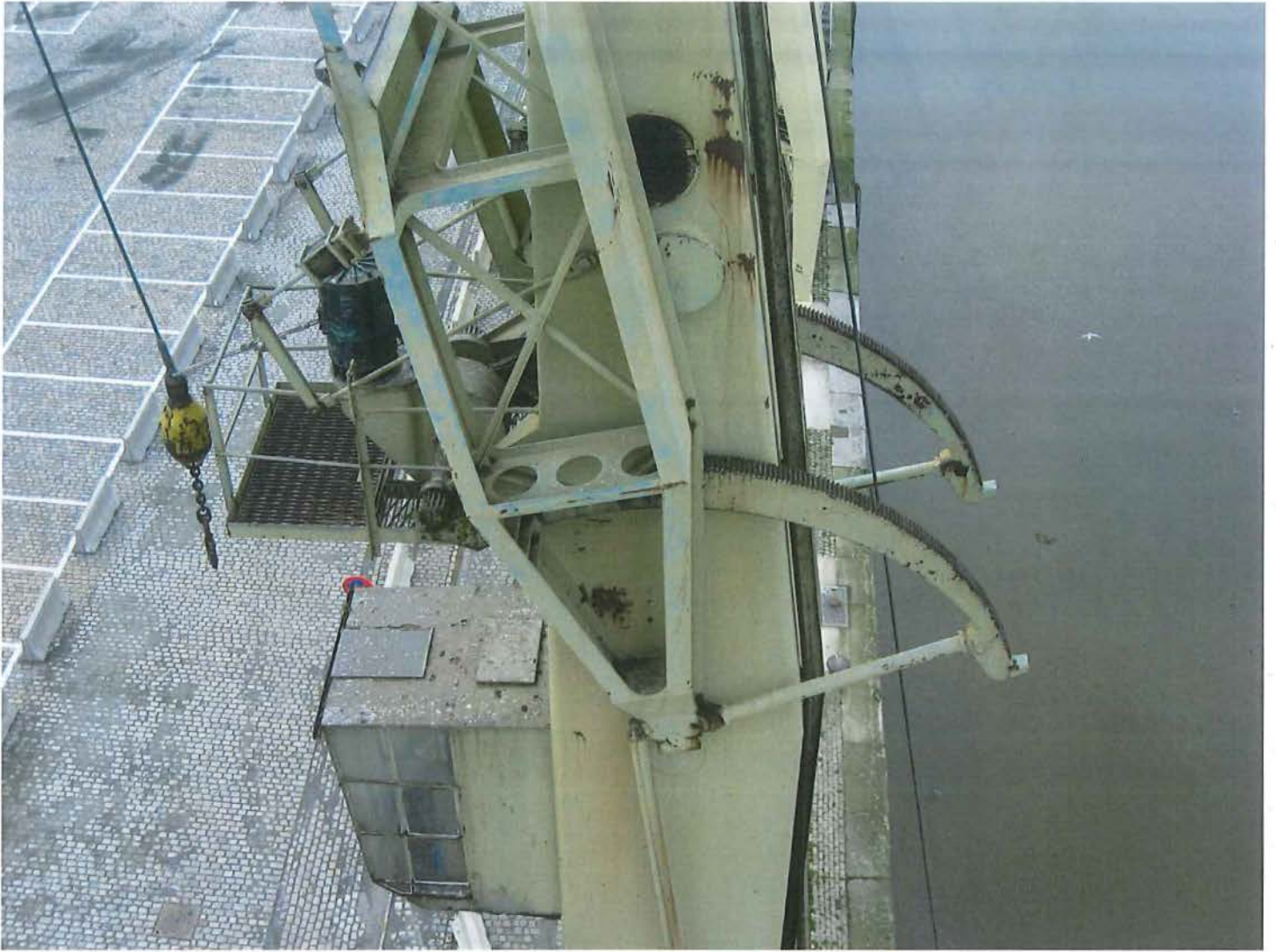
Foto 18: De giekvoet, het topmechanisme, de hijshaak en de stuurcabine.
